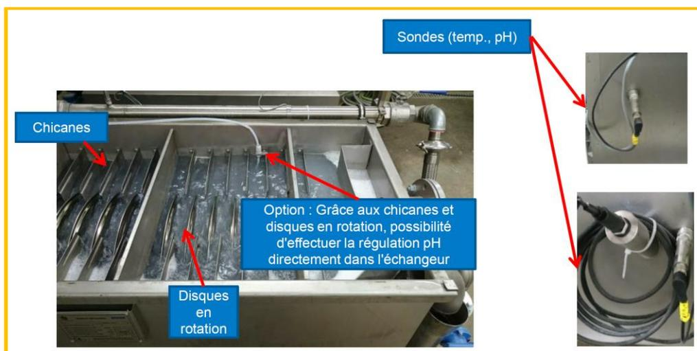
Figure 11 : Régulation de pH dans l'EOP (source ECOLAB)
